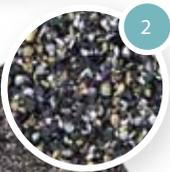
**2** Cobertura de granulos y adhesión. Extraemos, trituramos y coloreamos nuestros granulos a las especificaciones exactas. Los propósitos principales de los granulos son proteger el asfalto subyacente contra los daños causados por los rayos dañinos del sol y para ayudar a inhibir el proceso natural de la intemperie. Nuestra exclusiva y avanzada tecnología de mezcla de colores crea hermosas mezclas de colores de alta definición que a usted le encantará ver en su casa.
